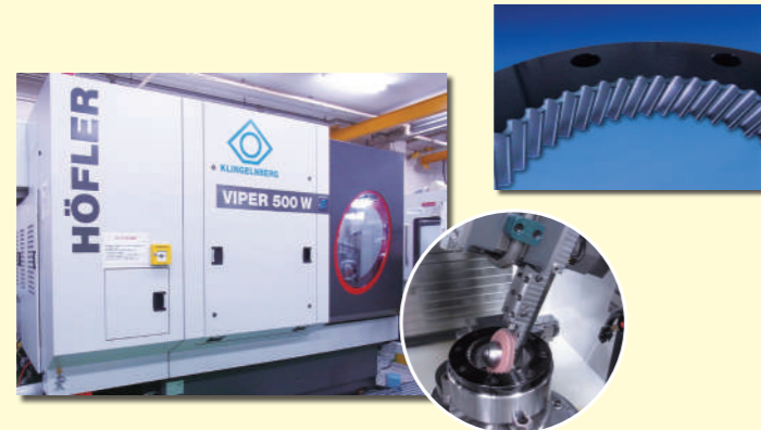
KLINGELNBERG 公司制造的齿轮磨削床 VIPER500W
