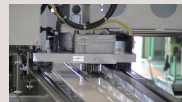
在工件搬送装置上使用的 KRG 磨齿齿条
