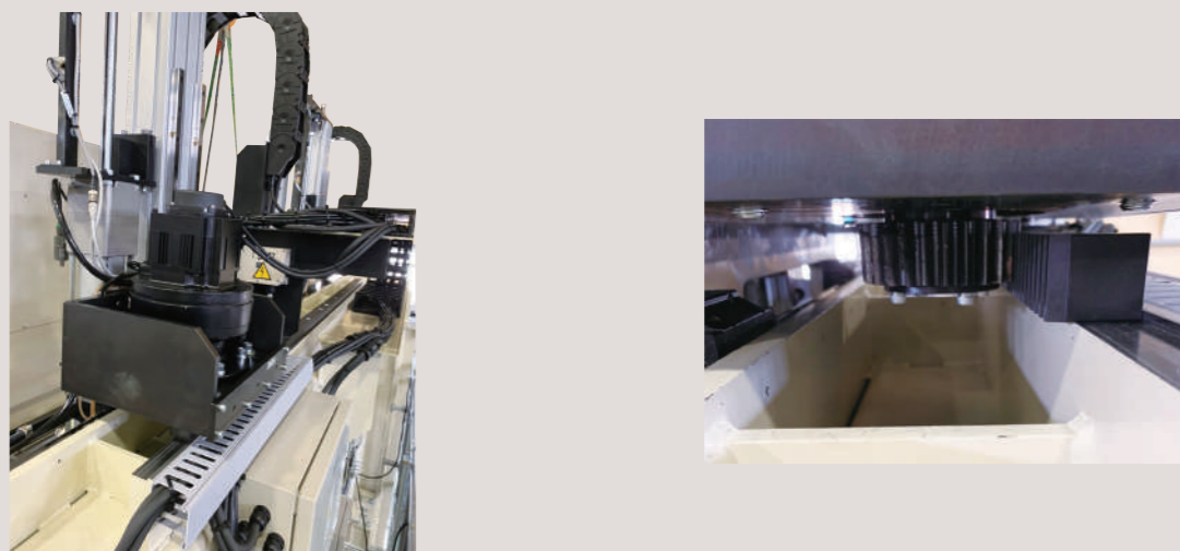
汽车零部件的自动搬送清洗装置使用的 SRCPF-H 齿条和 SSCP 直齿轮
